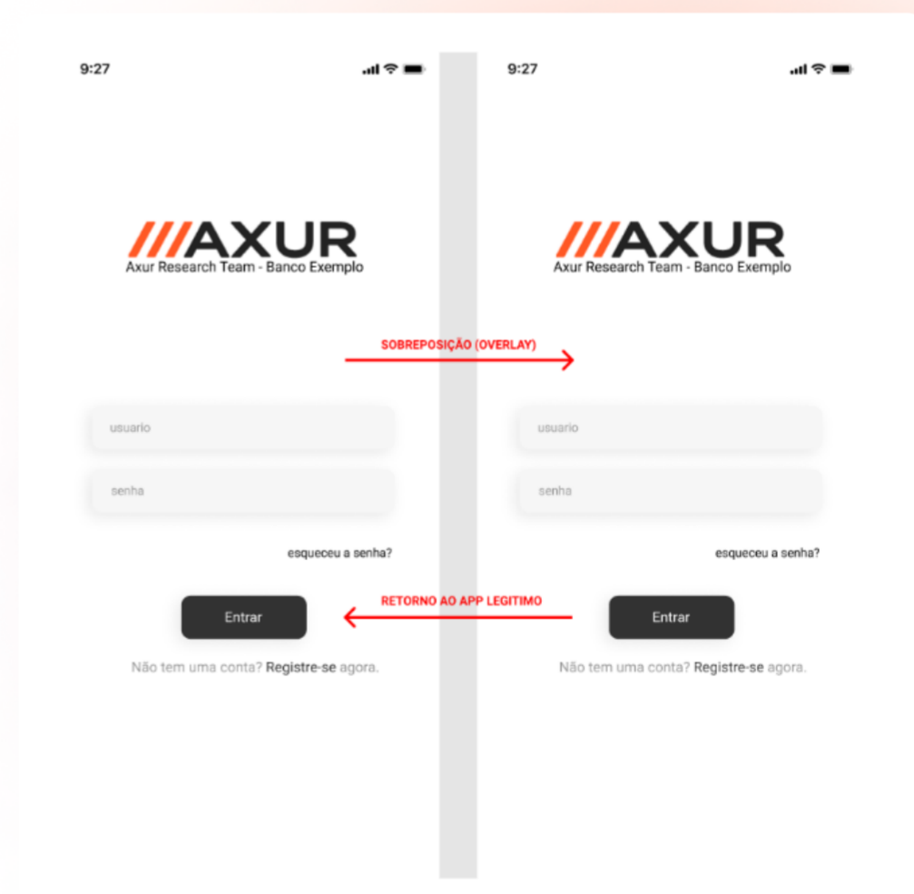
Figura 2: Overlay criado pelo Sharkbot permite capturar credenciais durante o fluxo de um app legítimo.
